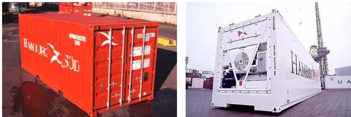
Figura 0.1 Contêiner para carga seca (esquerda) e para carga refrigerada (direita).
